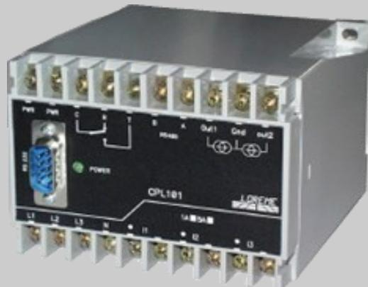
Le CPL101 est un transmetteurs programmable destinés à la mesure des paramètres de réseaux électriques. il couvre la totalité des configurations de câblage réseau rencontré dans l'industrie. Pourvu d'un large éventail de sorties, il peut être utilisé en analyseur, convertisseur, compteur d'énergie, régulation ou protection.
